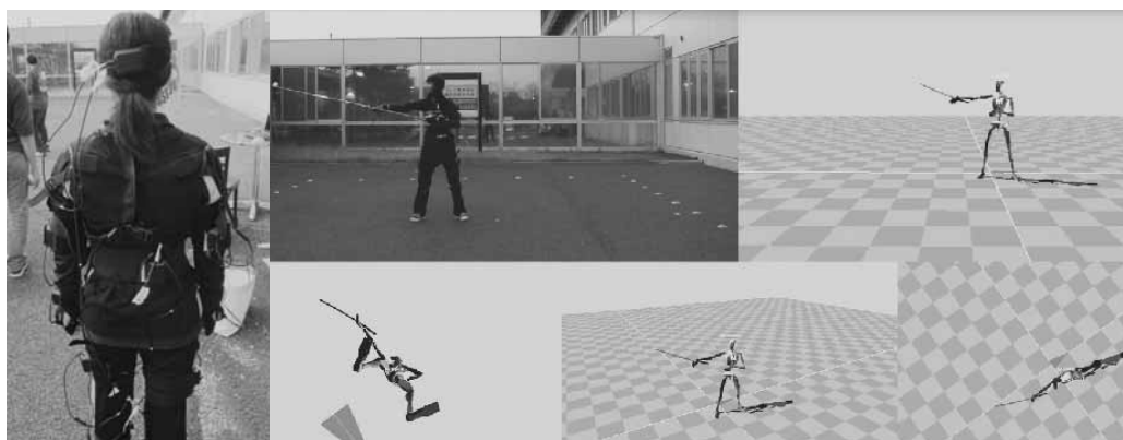
図2. モーションキャプチャーシステムによる3次元動作解析
